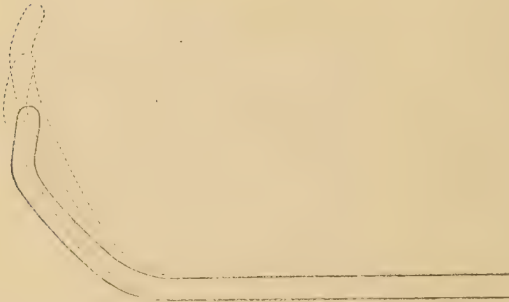
FIG. 4. — Positions successives de la sonde, quand on a poussé simplement, sans bouger le mandrin.
